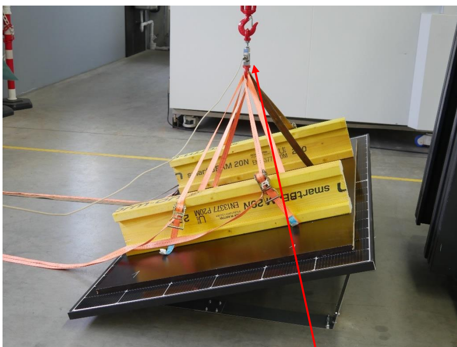
Abbildung 5 – seitliche Ansicht mit Kraftmesssensor
