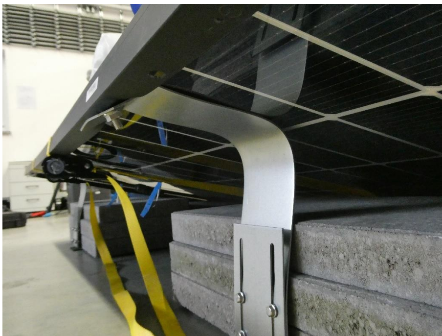
Abbildung 30 – Einknicken der Halterung bei 510 kg
