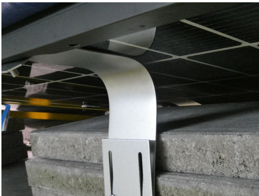
Abbildung 20 – Einknicken der Halterung bei 450kg
