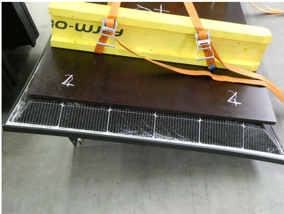
Abbildung 14 – Bruch der Glasplatte
