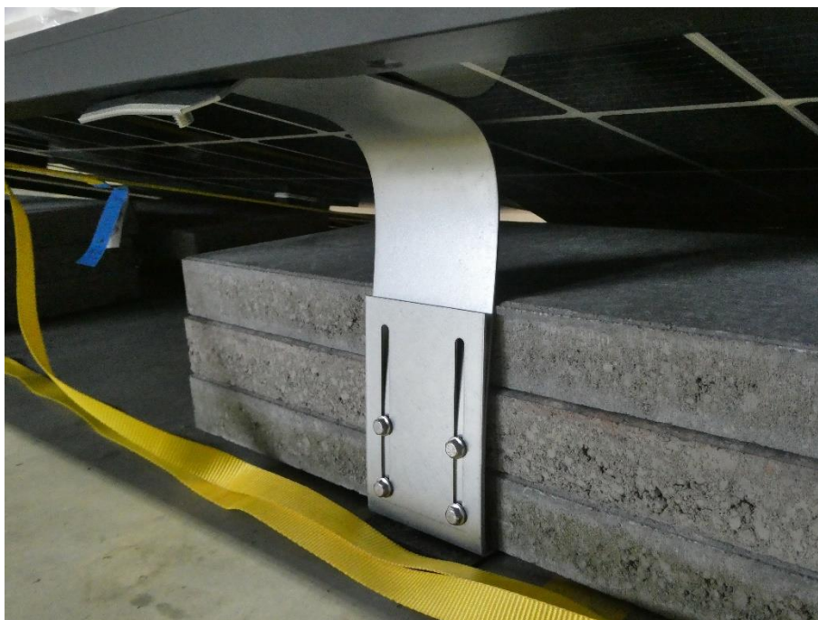
Abbildung 25 – Einknicken der Halterung bei 530kg
